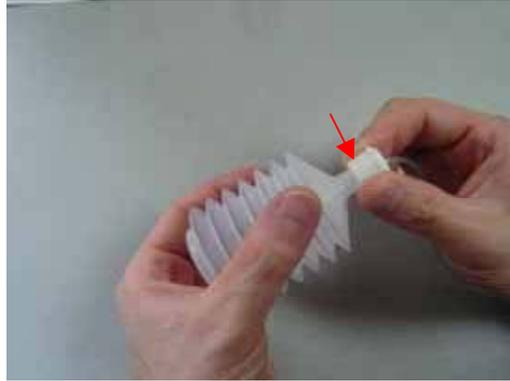
2. キャップを再び閉め、タンクを圧縮して排液します。
